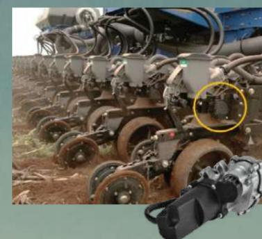
Desligamento de sementes linha a linha utilizando o sistema E-Drive com motor elétrico.
