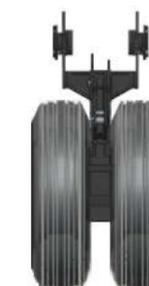
Rodado com eixo curto: mais durabilidade e resistência, correntes protegidas. Pneus com garra de fábrica.
