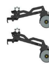
Trabalha com braços de adubo pantográfico ou pivotado.
