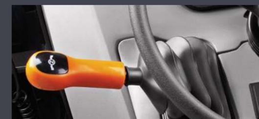
O sistema Synchro Shuttle™ realiza rápidas mudanças de direção.
