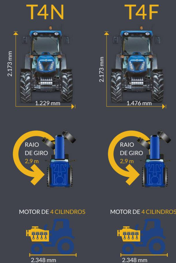
A mesma versatilidade pode também ser vista na altura máxima. No trator cabinado de 88 cv, por exemplo, ela chega a 2,17 m. Enquanto isso, na versão plataformada, com o ROPS (arco de proteção) rebatido na posição horizontal, à altura
